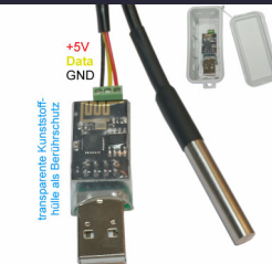
Die Spannungsversorgung erfolgt entweder über den USB-Stecker mit einem USB-Stromkabelteil oder einer USB-Powerbank oder über die Schraubklemmen +5V und GND mit externem Spannungswandler +12V bis +24V nach +5V.
