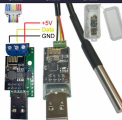
Die Spannungsversorgung erfolgt entweder über den USB-Stecker mit einem USB-Stromkernsteckernetzteil oder einer USB-Powerbank oder über die Schraubklemmen +5V und GND mit externem Spannungswandler +12V bis +24V nach +5V.
