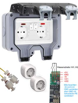
Eine Störung wird per email und an einen optionalen Alarmkontakt gemeldet. Ist eine der beiden Pumpen defekt, kann diese in aller Ruhe getauscht werden, da die verbleibende Pumpe weiterhin angesteuert wird. Die Daten können mit MQTT weiter gegeben werden. Die Programmierung erfolgt per Browser am Handy.
