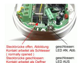
In der Regel werden die Bewegungsmelder am SMS-GUARD als Oeffner betrieben (normally closed) . Sollen die Melder als Schliesser (normally opened) arbeiten, so ist die linke Steckbrücke, wie in der Abbildung zu sehen, zu ziehen und in Parkposition zu stecken. Am entsprechenden Eingang muss nun die Funktione Oeffner ausgeschaltet werden, mit e2.oe=0.
