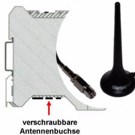
Die Antenne sollte vor Anlegen der Versorgungsspannung installiert sein und darf im Betrieb des Gerätes nicht gezogen werden - Zerstörungsgefahr!
