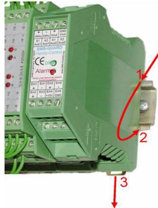
Zum Lösen des SMS-GUARD von der Hutschiene hebeln Sie mit einer Schraubenzieherspitze die Metallklammer (3) in Pfeilrichtung nach unten und kippen das Gehäuse nach oben von der Hutschiene um den Punkt (1) weg.
