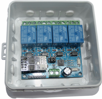
4 Relaisausgänge normally open "no" und normally closed "nc" belastbar mit je 48V AC/DC 2A resistiv
